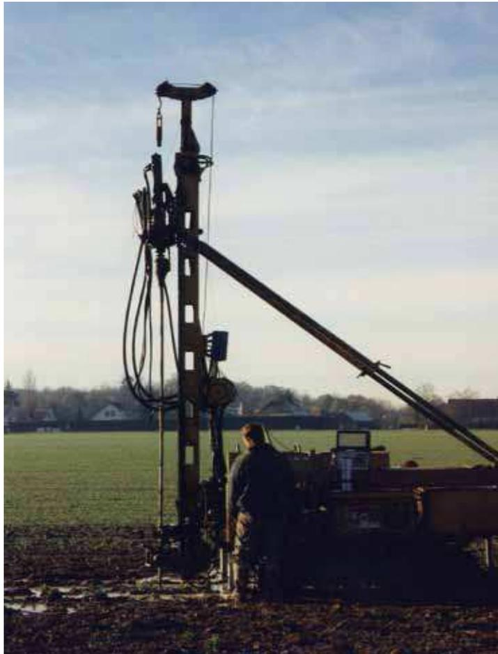
*Photographie d'un forage destructif (photo DDTM27)*
